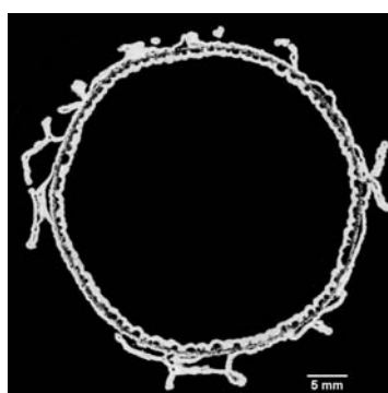
Abb.2: CT-Schnittbild eines Koksrohres
