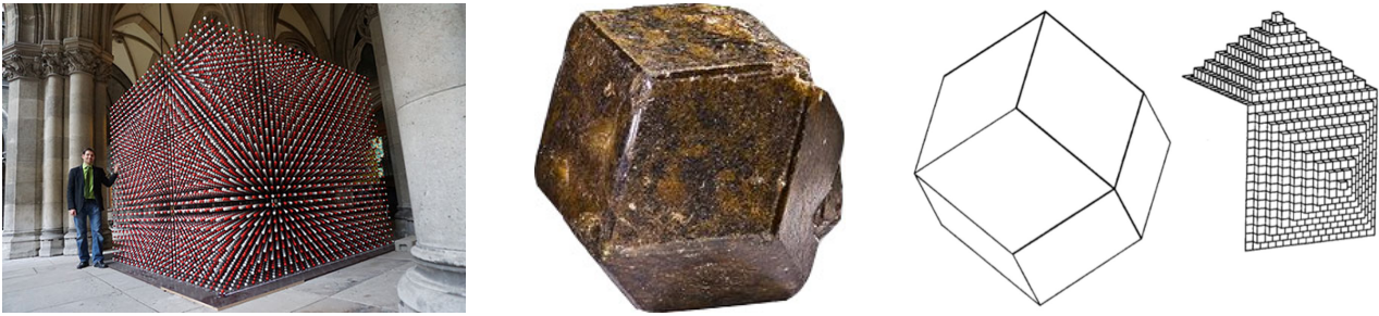
Abb. 4: Kristallmodell als regelmäßige, periodische Anordnung von Kugeln (links), regelmäßiger Kristallkörper (Form: Rhombendodekaeder bzw. 12-Flächner) eines natürlich gewachsenen Granat-Kristalls (Mitte), Rhombendodekaeder zusammengesetzt aus Würfeln (rechts)
