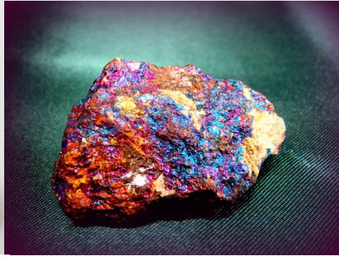
Abb. 4: Buntkupferkies (Bornit, Cu 5 FeS 4 ) mit typischen Anlauffarben
